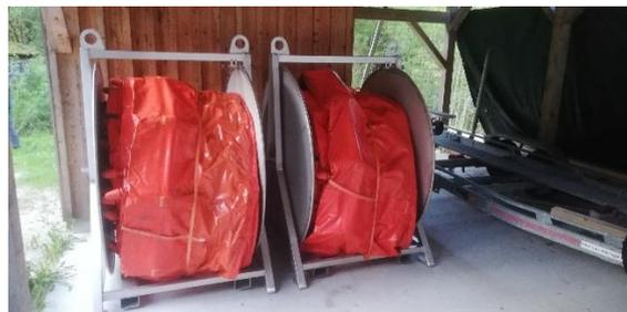
Auch für die Lagerung unserer Ölsperren gab es endlich eine Lösung. Vom Landesfeuerwehrkommando wurden uns Haspeln zur Verfügung gestellt, wo die Sperren jetzt schon zusammengehängt aufgerollt werden können. Somit müssen diese nicht mehr lose im Anhänger herumliegen und können nun auch per Stapler oder Kran an beliebige Orte transportiert werden.
